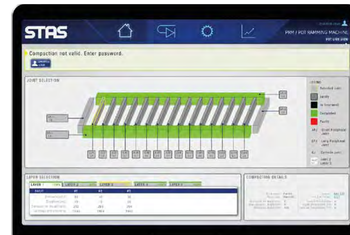
◀ HMI : capture d'écran du panneau de contrôle de la qualité
