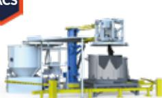
Écumeur hydraulique d'aluminium en creuset
