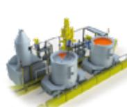
Robot écumeur d'aluminium en creuset
