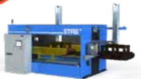
Système d'inspection 3D des mégots d'anodes
